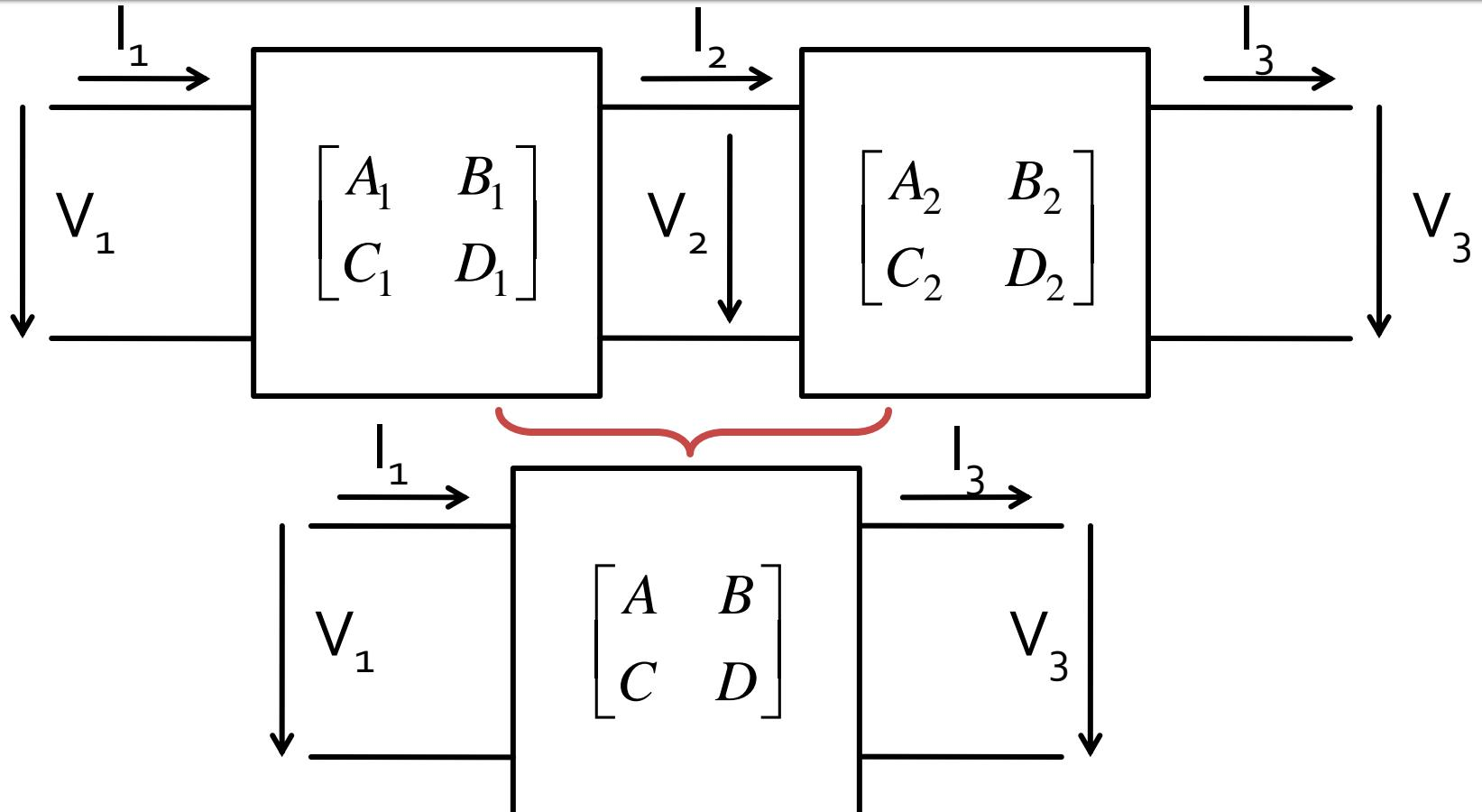
$$\begin{bmatrix} A & B \\ C & D \end{bmatrix} = \begin{bmatrix} A_1 & B_1 \\ C_1 & D_1 \end{bmatrix} \cdot \begin{bmatrix} A_2 & B_2 \\ C_2 & D_2 \end{bmatrix}$$
