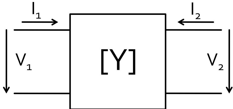
$$\begin{bmatrix} I_1 \\ I_2 \end{bmatrix} = \begin{bmatrix} Y_{11} & Y_{12} \\ Y_{21} & Y_{22} \end{bmatrix} \cdot \begin{bmatrix} V_1 \\ V_2 \end{bmatrix}$$
