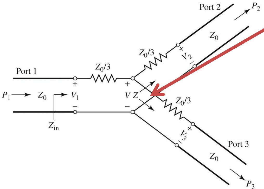
Impedanta  $Z$  vazuta de la nivelul jonctiunii spre una din linii:
